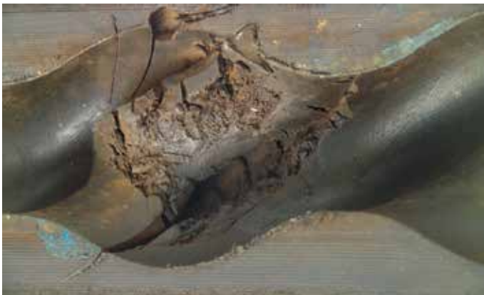
Ausfall nach ca. 3.000 Stunden durch Ablösung von Statorteilen
