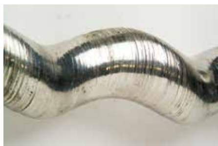
Ausfall nach ca. 3.000 Stunden durch Ablösung von Statorteilen
